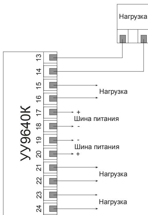
Рис. 47 Подключение нагрузки.
