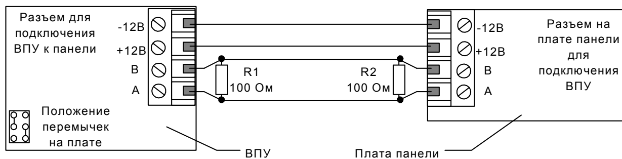
Рис. 8 Подключение выносного пульта управления к панели.
