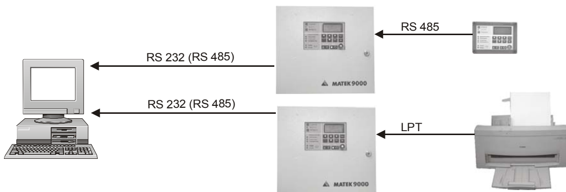
Рис. 11 Вариант объединения панелей.
