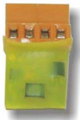
Устройство приемно-контрольное УК9002 предназначено для адресации извещений от датчиков состояния (включено/выключено, открыто/закрыто, исправно/ неисправно, перегрев/ норма и т.д.), с контактным выходом, с контролем цепи «tamper».
