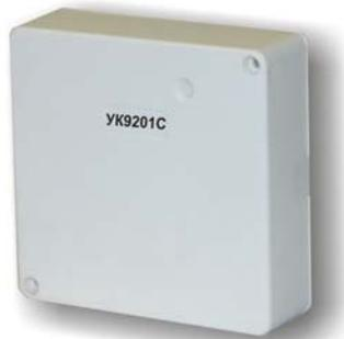
Устройство приемно-контрольное УК9201С предназначено для подключения одного гальванически изолированного, двухпроводного шлейфа сигнализации (аналогичного ППК-2), его контроля и передачи на панель информации о состоянии шлейфа.
