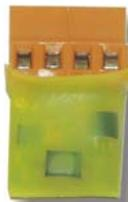
Устройство приемно-контрольное УК9101 предназначено для адресации извещений о пожаре, тревоге, неисправности от пожарных, охранных и других извещателей с токовым или контактным выходом, по двухпроводному шлейфу сигнализации и его контроля на замыкание или обрыв.
