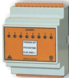
Устройство приемно-контрольное УК9608 предназначено для контроля состояния 8 шлейфов сигнализации и передачи извещений по адресной шине в панель с указанием адреса шлейфа. К шлейфам сигнализации подключаются охранные и пожарные извещатели (и др. с токовым или контактным выходом). Устройство обеспечивает автоматический сброс пожарных извещателей.
