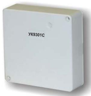
Устройство приемно-контрольное УК9301С предназначено для подключения одного гальванически изолированного, двухпроводного шлейфа сигнализации, его контроля и передачи на панель информации о состоянии шлейфа.
